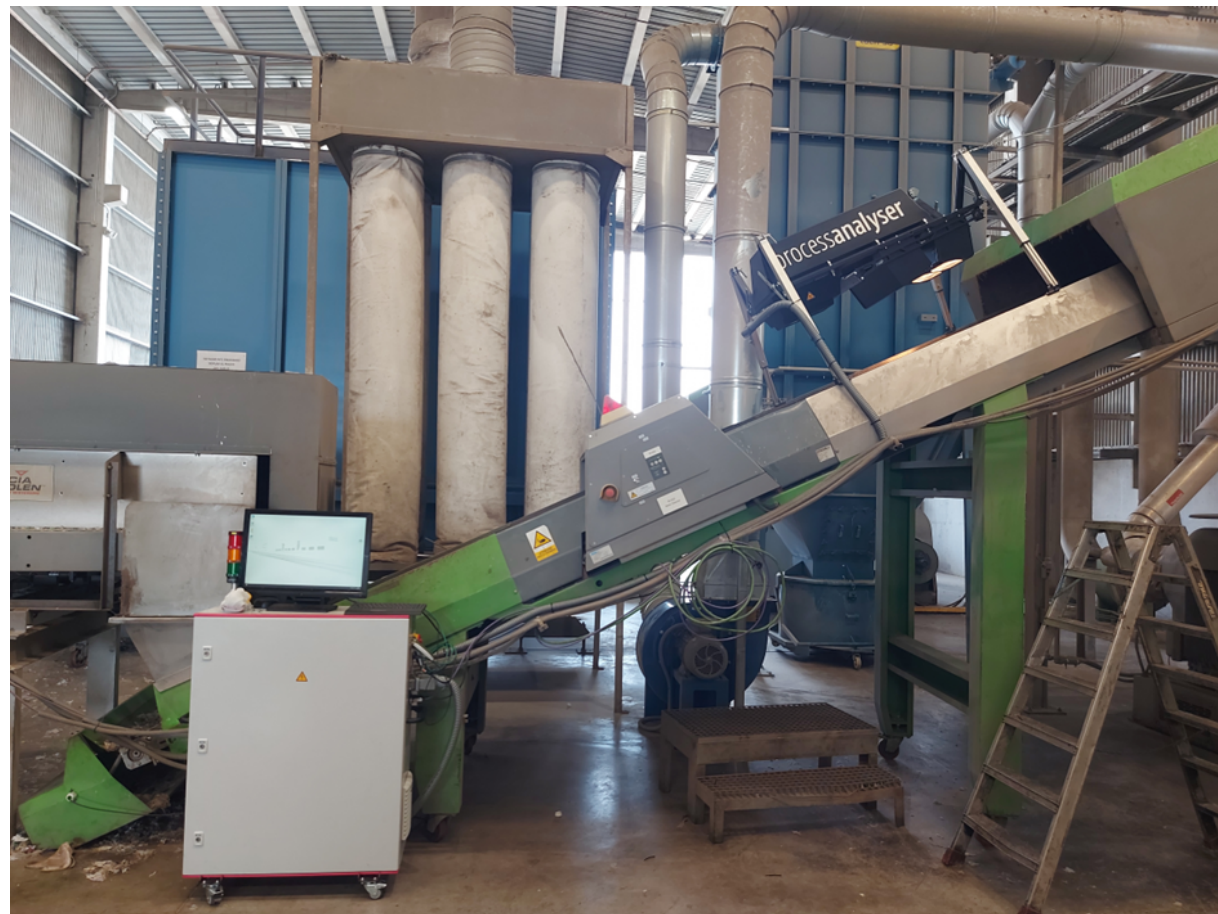
Prozesskontrolle im Chemischen Recycling (2D Polyolefine)
